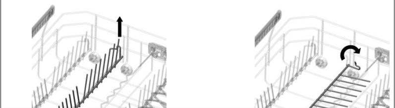
Inserts anti-goutte, permettant un meilleur séchage des assiettes. Vous pouvez les monter sur le panier ou dans la poche d'accessoires, auquel cas, il vous suffit, pour les utiliser, de les enfiler à l'emplacement prévu comme indiqué sur le schéma.
