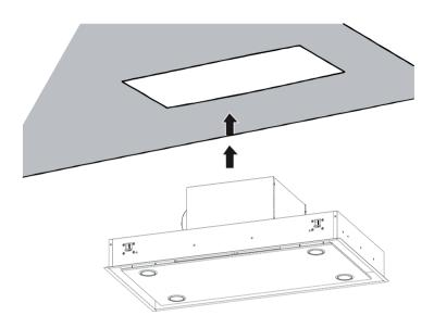
• In tutti i casi in cui il Soffitto non fosse sufficientemente robusto sul punto di sospensione, l'Installatore dovrà provvedere a irrobustirlo con opportune piastre e contropiastre ancorate a parti strutturalmente resistenti.
