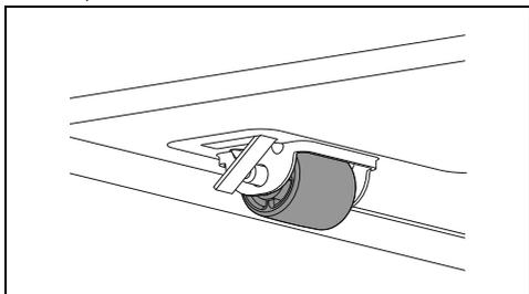
Contudo, aconselha-se a prestar muita atenção durante a deslocação, para que o deslizamento não danifique o pavimento (por exemplo, se o frigorífico estiver colocado sobre soalho).
