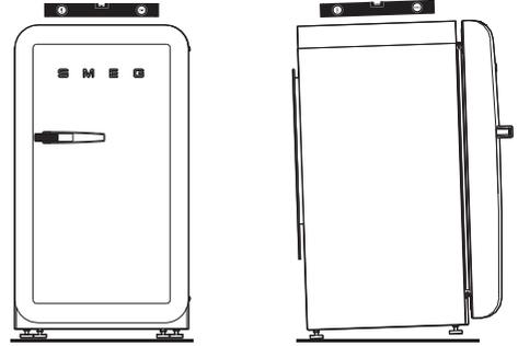
Pasados unos días desde la instalación, verifique que la nivelación inicial sea todavía correcta. Controle que el aparato permanece estable cuando está en funcionamiento y cargado con alimentos, y que las juntas de la puerta cierran herméticamente. Si es necesario, efectúe una nueva nivelación y ajuste nuevamente las juntas.
