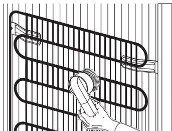
Para fomentar el ahorro energético y la eficacia del aparato, limpie periódicamente el condensador de la parte trasera mediante el uso de una escoba, un aspirador o un paño.
