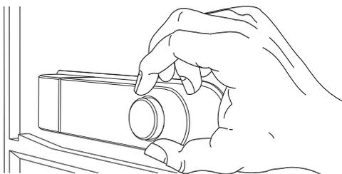
El mando situado en la parte superior derecha del aparato permite regular la temperatura de enfriamiento.
