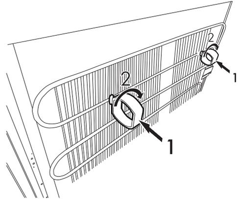
Para colocar los distanciadores, introdúzcalos entre las barras verticales del condensador (1) y, a continuación, gírelos 90 grados hacia la derecha o la izquierda para fijarlos (2).
