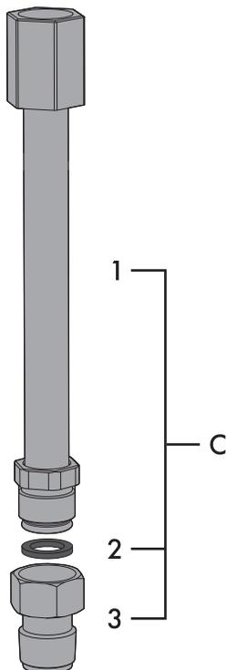
4. Avvitare la prolunga assemblata **C** al raccordo gas dell'apparecchio **D** interponendo sempre la guarnizione **2** in dotazione.
