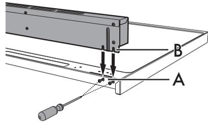
4. Fissare l'alzatina al pianale tramite le 4 viti precedentemente allentate.
