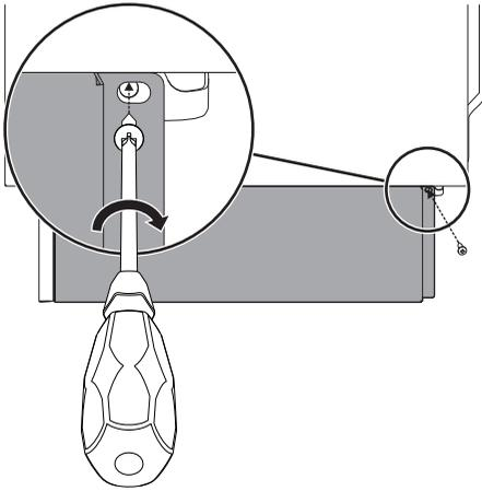
5. Fissare lo zoccolo laterale all'apparecchio tramite la vite precedentemente rimossa.
