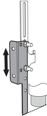
4. Allineare la base del gancio della staffa di fissaggio con la base del taglio della piastrina di fissaggio al muro.
