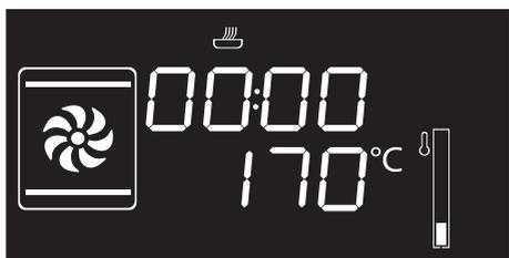
2. Gire el mando de la temperatura a la derecha o a la izquierda para ajustar los minutos de cocción de 00:01 a 12:59. Mantenga girado el mando para obtener un aumento o una disminución más rápidos.
