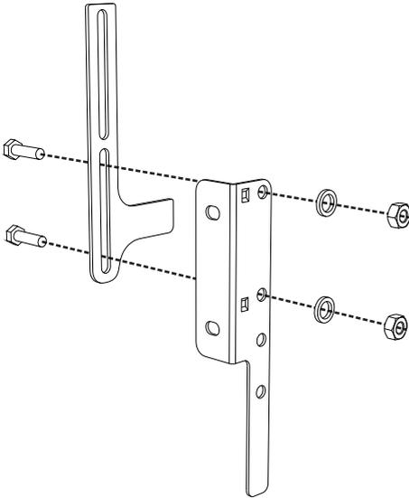
5. Alinee la base de la abrazadera de fijación hasta el suelo y apriete los tornillos para fijar las medidas.
