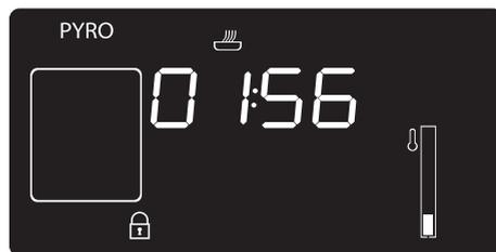
1. En la pantalla aparece la leyenda **PYRO ECO** o **PYRO ECO** y el tiempo restante para indicar que el aparato está efectuando el ciclo de limpieza automático.
