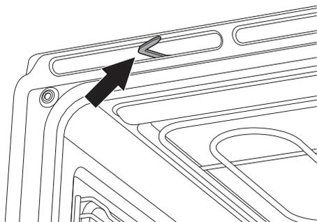
Durante las operaciones normales de limpieza, puede suceder que se active accidentalmente la palanca del bloqueo de la puerta.
