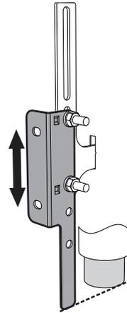
4. Alinee la base del gancho del soporte de fijación con la base del corte de la placa de fijación a la pared.
