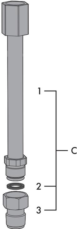
4. Enrosque la extensión montada **C** en el manguito del gas del aparato **D** interponiendo siempre la junta **2** que se suministra.
