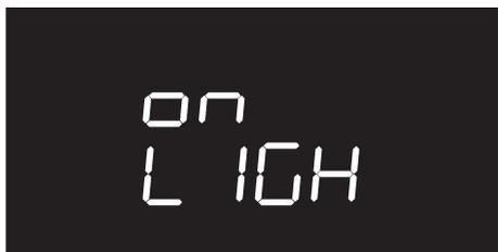
Para impedir que el aparato desactive la lámpara pasado un minuto ajuste en OFF esta función.
