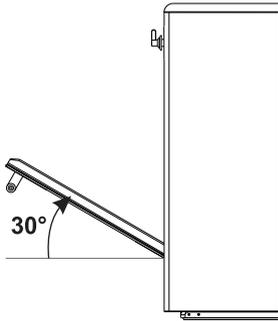
3. Para volver a montar la puerta coloque las bisagras en las hendiduras correspondientes situadas en el horno asegurándose de que las ranuras **A** se apoyen completamente en las hendiduras. Baje la puerta y, una vez posicionada, quite los pernos de los agujeros de las bisagras.
