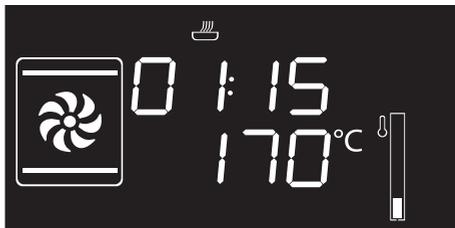
3. Algunos segundos después de haber seleccionado la duración deseada, la luz testigo
