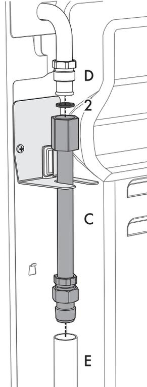
5. Aplique material aislante a la rosca de la extensión montada **C** y luego enrosque el tubo flexible **E**.
