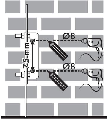
8. Después de haber hecho los agujeros en la pared, utilice tacos con tornillos para fijar la abrazadera a la pared.
