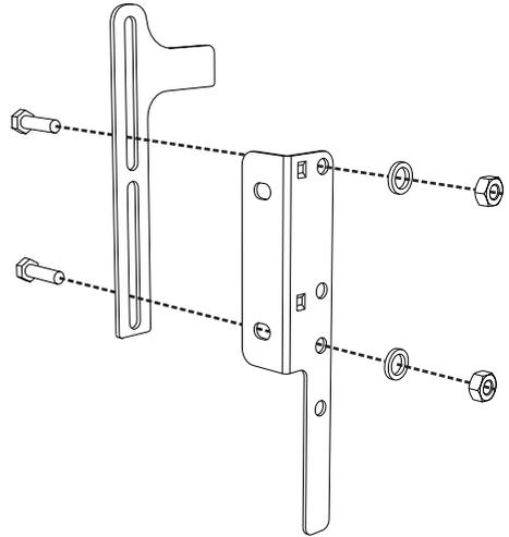
4. Allineare la base del gancio della staffa di fissaggio con la base del taglio della piastrina di fissaggio al muro.
